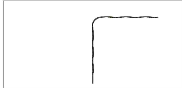
2) Se orientando pelo código de cor, faça a aplicação de uma das pernas da Derivação “T” sobre o cabo de derivação.
