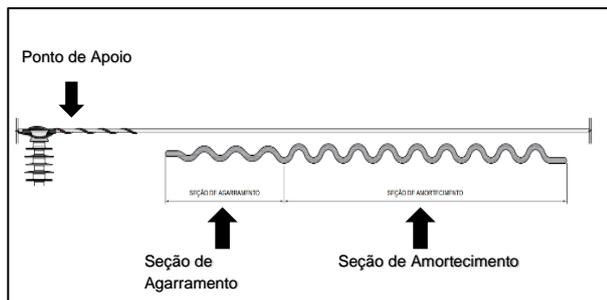
1) Posicione o Amortecedor de Vibração com a seção de agarramento voltada para o ponto de apoio do cabo;
