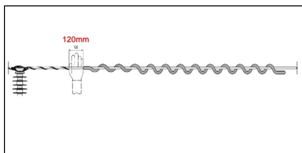
4) Finalize a aplicação do Amortecedor de Vibração com a seção de agarramento. **Obs.:** Após finalizada a aplicação, verifique se a distância entre o ponto de apoio com o início do Amortecedor de Vibração ficou com 120mm.
