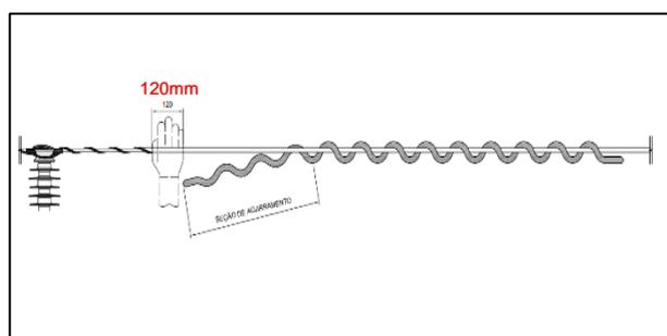
3) Após aplicada a seção de amortecimento, deixe uma distância de 120mm ou um palmo de mão fechada entre a seção de agarramento com o ponto de apoio;
