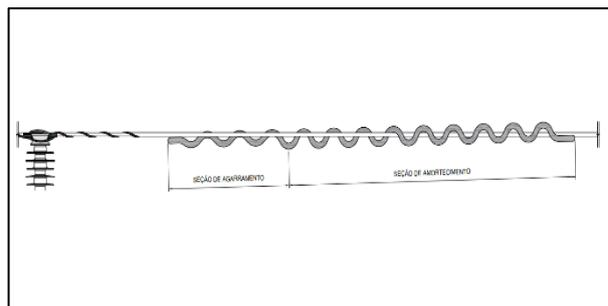
2) Inicie a aplicação pela extremidade da seção de amortecimento, girando-a sobre o cabo em direção contrária ao ponto de apoio;
