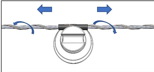
**3)** Puxe as pernas do Laço Lateral Simples Preformado em sentidos opostos, formando um "x" no condutor. Na sequência faça a aplicação no condutor, seguindo o mesmo sentido do encordoamento. **Nota:** O Laço Preformado deverá envolver o condutor pela abertura do coxim, a não observância desse detalhe poderá danificar o Laço Preformado, ou o coxim ou ambos.
