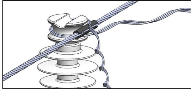
**2)** Posicione o Laço Lateral Simples Preformado no pescoço do isolador, passando uma perna por cima e a outra por baixo do condutor, de forma que este fique no meio.
