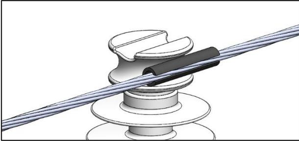
**1)** Coloque o coxim de elastômero no condutor e posicione-o em contato com o centro do pescoço do isolador. A abertura do coxim deverá ficar para fora.
