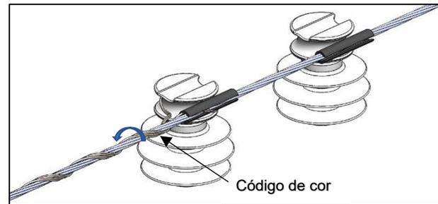
4) Coincida o código de cor da segunda perna com o condutor e em seguida faça a aplicação da mesma, envolvendo-a no condutor.
