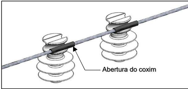
1) Coloque os coxins de elastômero no condutor e posicione-os em contato com o pescoço dos isoladores. A abertura dos coxins deverá ficar para fora.
