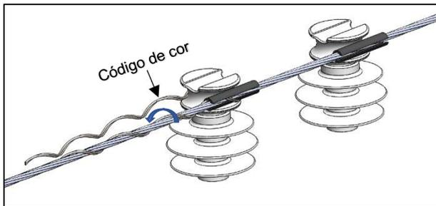
3) Comece a aplicação pela perna do Laço Preformado que está do lado do coxim, envolvendo-a no condutor. **Nota:** O Laço Preformado deverá envolver o condutor pela abertura do coxim (vide imagem ao lado), a não observância desse detalhe poderá danificar o Laço Preformado, ou o coxim ou ambos.
